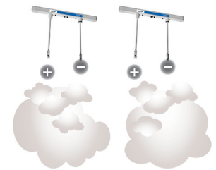
Los sistemas de DC pulsado crean nubes de iones positivos y negativos
